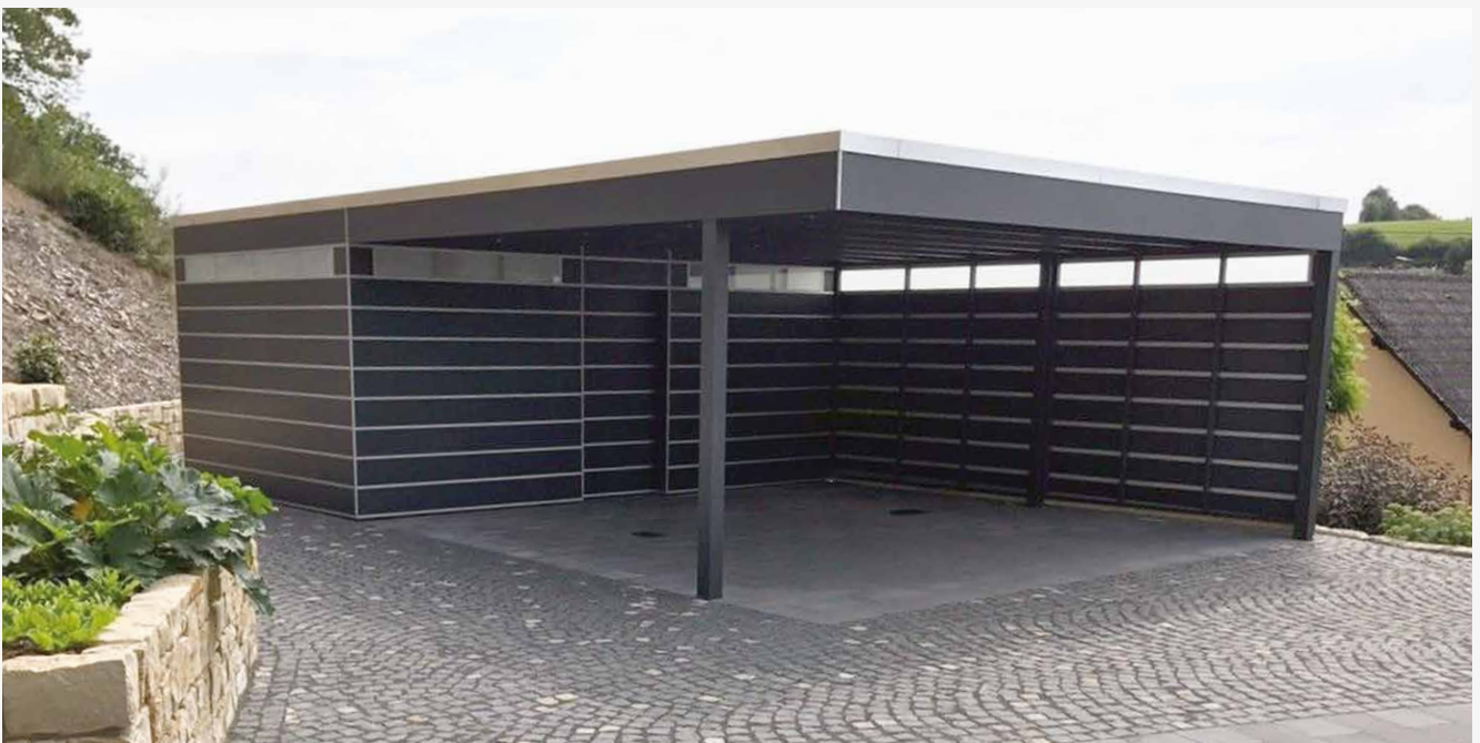
Carport / Flachdach Bauhaus HPL-Trespa® Hochwertige Leimholz-Konstruktion mit Seitenwand und Stahlpfosten
